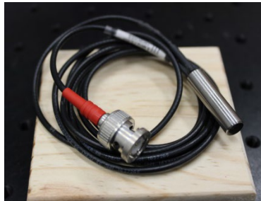
Figura 6.4.2. Transductor de 8 MHz de frecuencia ultrasónica y 5 mm de diámetro piezoeléctrico
